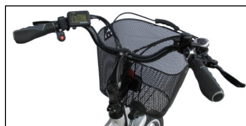
LCD PAS Display hydraulische Bremsen 7-Gang Shimano-Schaltung ergonomische Handgriffe
