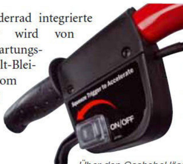
Über den Gashebel lässt sich die Fahrgeschwindigkeit stufenlos von 0 – 3,5 km/h regeln
